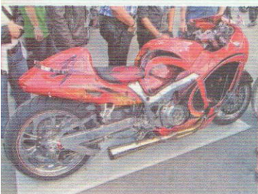
Die Spezial-Hayabusa der Streetfighters Interlaken mit Turbo und pneumatischem Fahrwerk.
